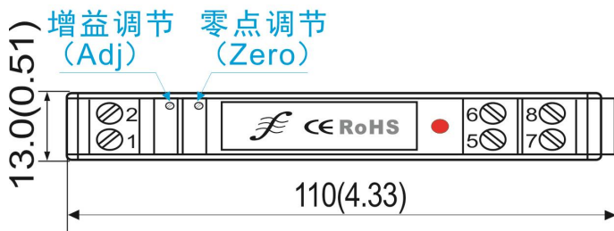
DIN2 系列小体积单路模拟量隔离放大器 隔离变送器
